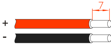
Rysunek 3–30 Schemat usuwania izolacji z wejścia DC (jednostka: mm)
