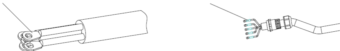
Rysunek 4-9: Schemat ilustrujący instrukcję podłączania przewodu zasilania sieciowego (1)
